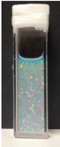
Figure 3.8 – Photographie d'un échantillon concentré de microgels cristallisés, les couleurs pailletées de l'échantillon sont dues à la diffraction de Bragg de la lumière blanche par les cristallites.
