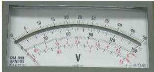
Mesure d'une tension avec un voltmètre de classe 1.5% sur le calibre 100 mV comportant 100 divisions. L'aiguille tombe entre les graduations 22 et 23.
