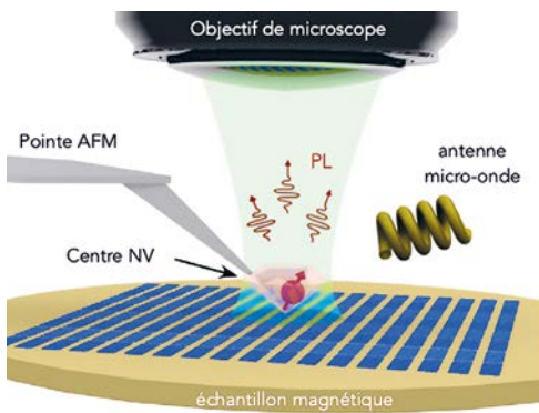
Figure 2 : Principe de la magnétométrie NV à balayage.
